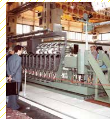
ITMA'83 (意大利, 米兰) 上展出细纱管纱的自动搬运系统 (管纱托盘式 / 细络联型)。特别是细络联系统的“托盘 to 托盘”方式在之后被多数纺纱企业所采用。
