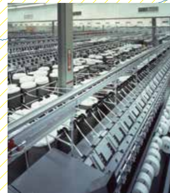
OTEMAS 上展出创新型空气纺纱机 MJS (Murata Jet Spinner: 村田喷气纺纱机)。不使用机械式转杯而是利用压缩空气的一种方式，实现了过去机器无法做到的的高速纺纱。
