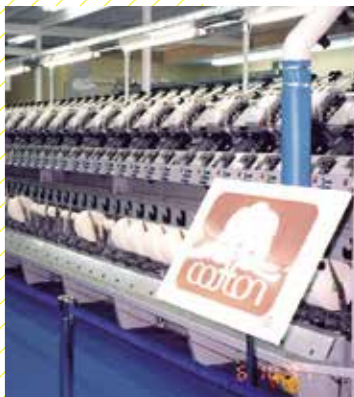
OTEMAS 上展出高速空气纺纱机 MVS (Murata VORTEX Spinner: 涡流纺纱机)。通过向下游市场宣传其吸水性、速干性、和抗起球性等传统纺纱方式不具有的优异特性来唤起市场需求，开拓了“VORTEX 涡流纺纱”这一新领域。
