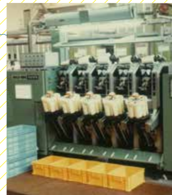
ITMA'79 (德国, 汉诺威) 上展出配置空气捻接器的自动络筒机“No.7-II MACH-CONER”。“无结纱线”的出现使得纺织制品的品质得到了极大的提升。
